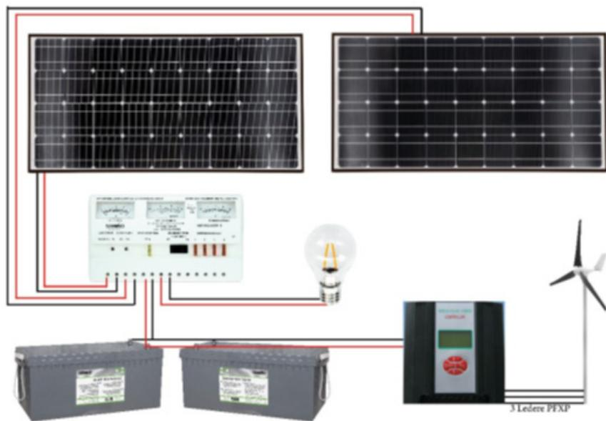
Eksempelet et solcelleanlegg kombinert med en vindmølle. Legg merke til at vindmølle har egen regulator som styrer vindmøllen. På tross av at denne har egen inngang for solcellepanel, anbefales det å benytte egen solstrøms-regulator i oppsettet.
