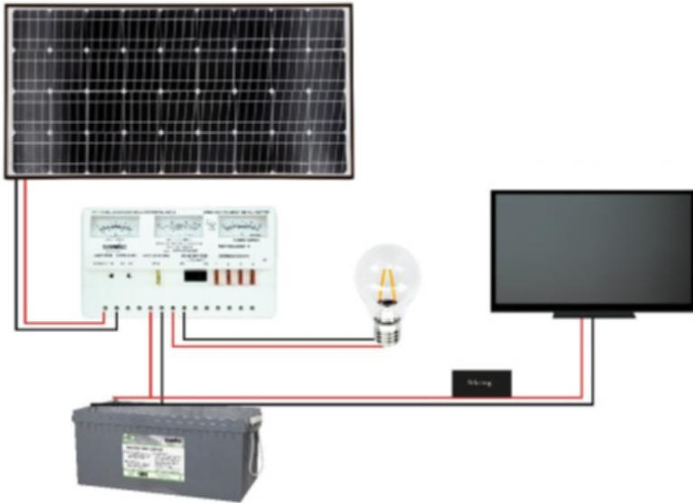
Dette er den vanligste formen for solanlegg på hytter. Anlegget er i 12V konfigurasjon og man har en eller flere forbrukskurser ut fra regulator. Anlegget kan utstyres med den maksimale effekten på paneler som regulator kan håndtere, samt at batterikapasiteten kan økes ved å parallellkoble flere batterier.
