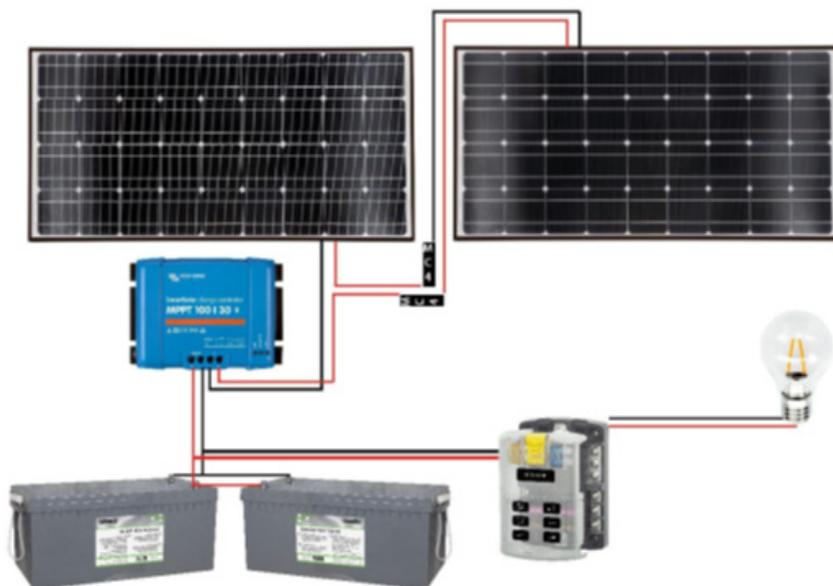
Anlegget er i 12V konfigurasjon og man har ingen forbrukskurser direkte fra regulator. Panelene er seriekoblet opp til høyere spenning, men batterispenningen er fortsatt 12V. Det er lagt opp til en egen fordelingsblokk for kurser til forbruk, da man henter denne strømmen rett fra batteriene. Seriekobling av paneler gir spesielt fordeler der kabelstrekke fra panel til regulator blir langt.
